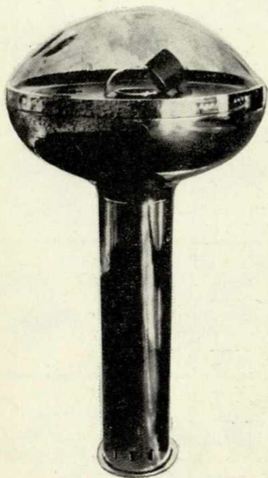
5. Устройство для демонстрации образца лунного грунта, доставленного советской космической ракетой «Луна-16»: 1 — луна, 2 — внешний стеклянный колпак, 3 — зеркало, 4 — колпак с гелием, 5 — лунный грунт, 6 — чаша, 7 — осветители, 8 — корпус, 9 — электрические блоки, 10 — стойка, 11 — вентилятор, 12 — подиум, 13 — опора
