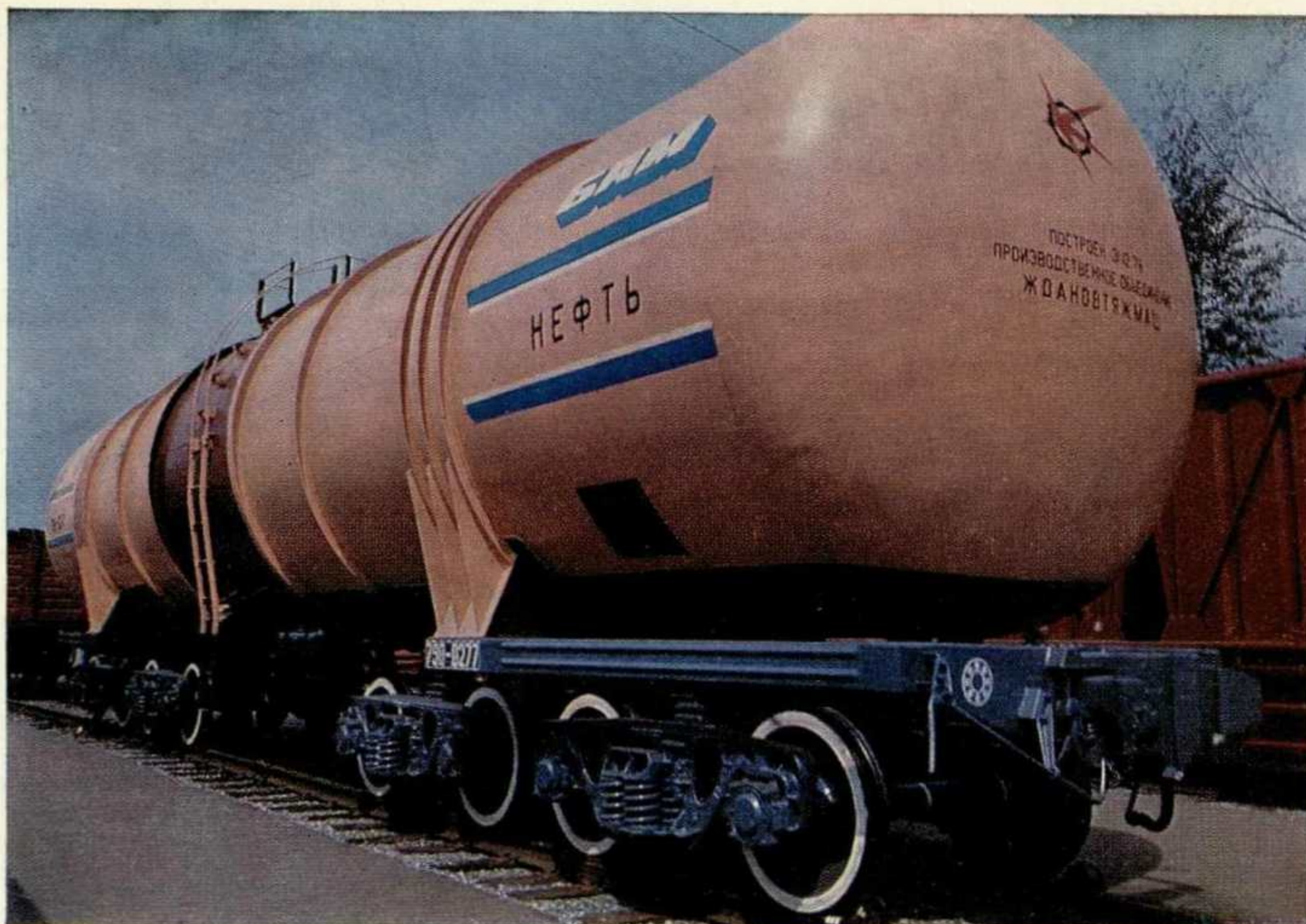
7. Восьмиосная цистерна грузоподъемностью 125 тс
